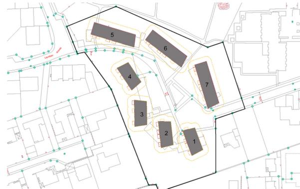
Die Wohnanlage besteht aus sieben dreigeschossigen Gebäuden in massiver Bauweise. Die Stahlbetongeschossdecken sind 20cm stark. Die tragenden Innenwände sind aus Kalksandstein und die Außenwände von Haus 1 und 2 sind aus Wärmedämmziegel. Die Häuser 3 bis 7 haben Außenwände aus Kalksandsteinmauerwerk und Wärmedämmverbundsystem. Die Fahrstuhlschachtwände bestehen aus 24er Stahlbetonwänden. Die räumliche Aussteifung erfolgt durch die Scheibenwirkung der Geschossdecken zusammen mit
