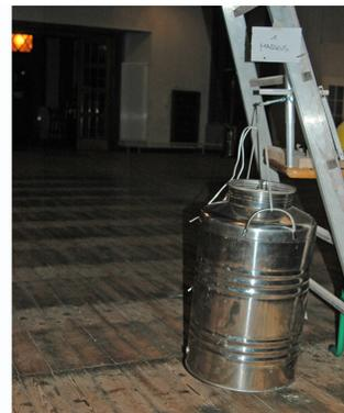
kann sind die Auflagerpunkte über ein umlaufendes Zugband verbunden. Aufgrund des hohen Schlankheitsgrades wird zusätzlich zum rechnerischen statischen Nachweis die Tragfähigkeit durch Probelastungen bestätigt.
